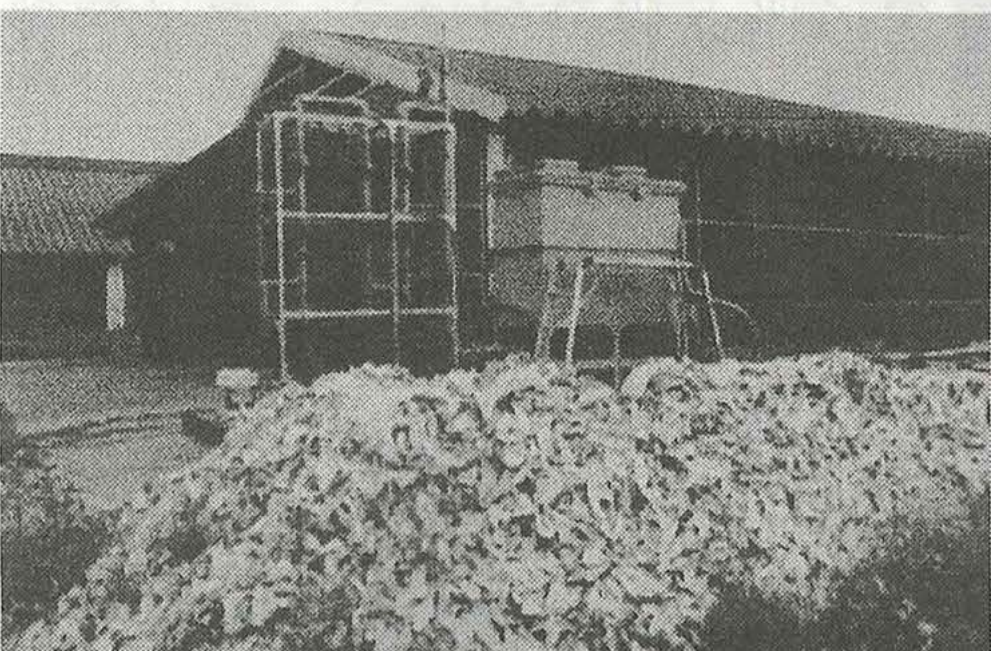
牡蠣殻抽出液で畜舎汚水処理(SKシグマエンジニアリング)
